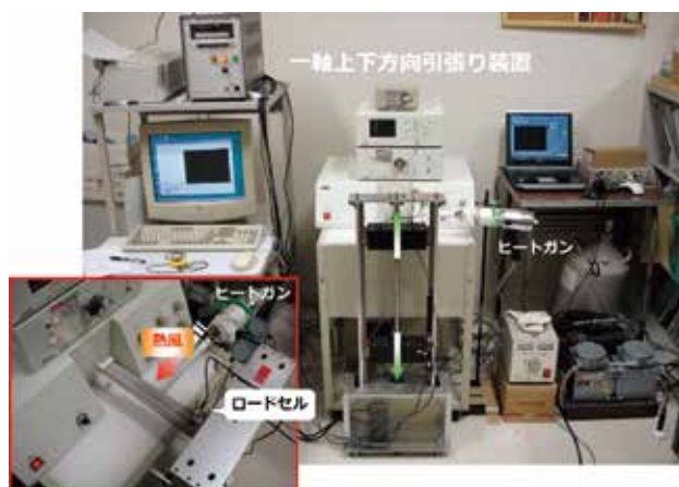
写真2 延伸過程を追跡可能なインプロセス NMR 計測システム
