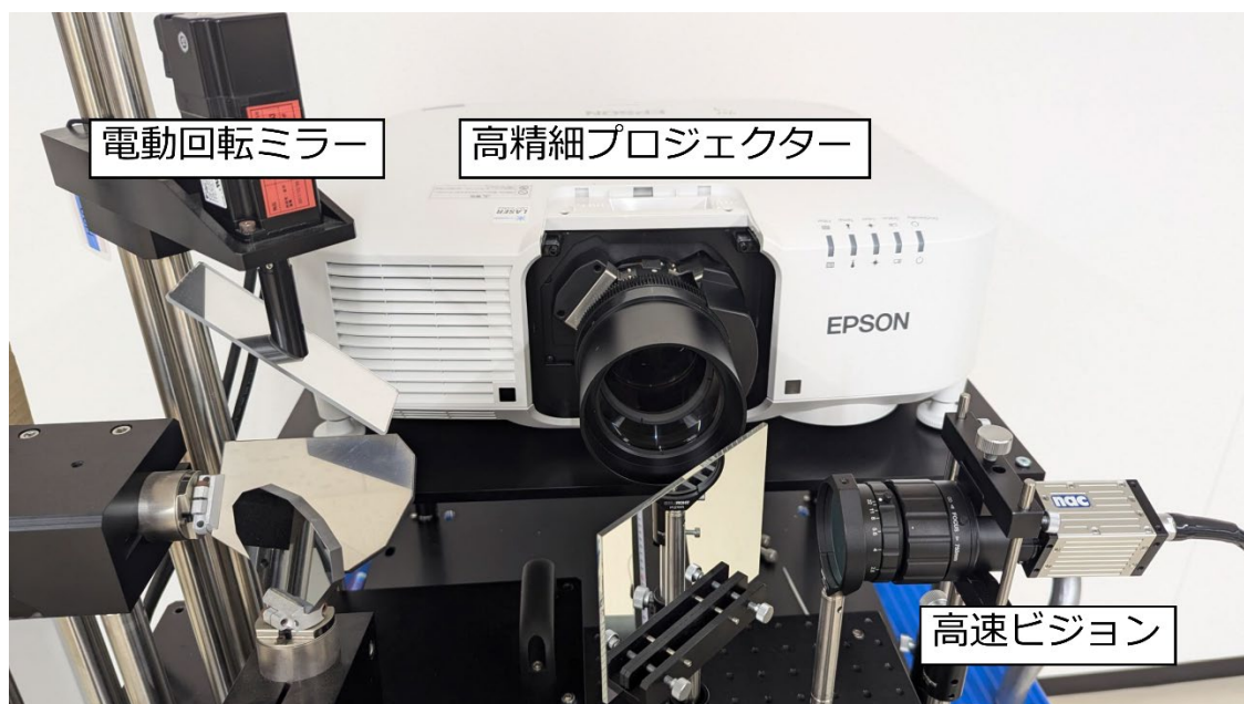
図2 開発した投影システムの写真
