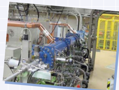
線形加速器／炭素イオンを主加速器であるシンクロトロンに送り込む前に予備的な加速を行います
