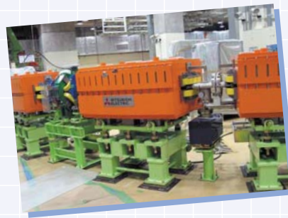
シンクロトロン加速器／線形加速器から送られてきた炭素イオンはシンクロトロンの中を周回している間に光速の70%まで加速されます
