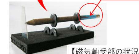
磁気により回転軸を浮かせ、摩擦・摩耗がない。高効率でメンテナンス性がよく、更新前に比べ約3倍の効率で運転が可能となった。
