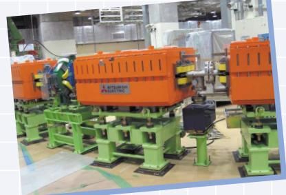
シンクロトロン加速器／線形加速器から送られてきた炭素イオンはシンクロトロンの中を周回している間に光速の70%まで加速されます
