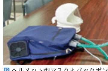
⑫ ヘルメット型マスクとバックポンプ（ポンプ・フィルター・各種センサー・バッテリーなどを収納）
