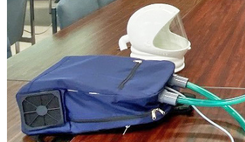
13 ヘルメット型マスクとバックポンプ（ポンプ・フィルター・各種センサー・バッテリーなどを収納）
