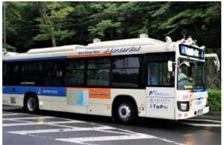
「遠隔監視・操作システム」で走行中の自動運転バス
