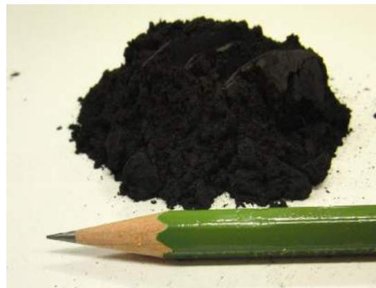
図2 開発したNO処理による窒素ドープ活性炭
