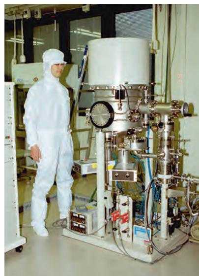
多元高周波スパッタ装置:本装置によってナノ多層膜が作製される。ナノ多層膜はその後、別の手法で微細加工される。(ATEC)
