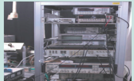
デバイス向け電流検出磁気共鳴装置
