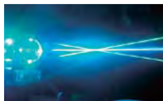
流れの速度を測る2色4本のレーザー光
