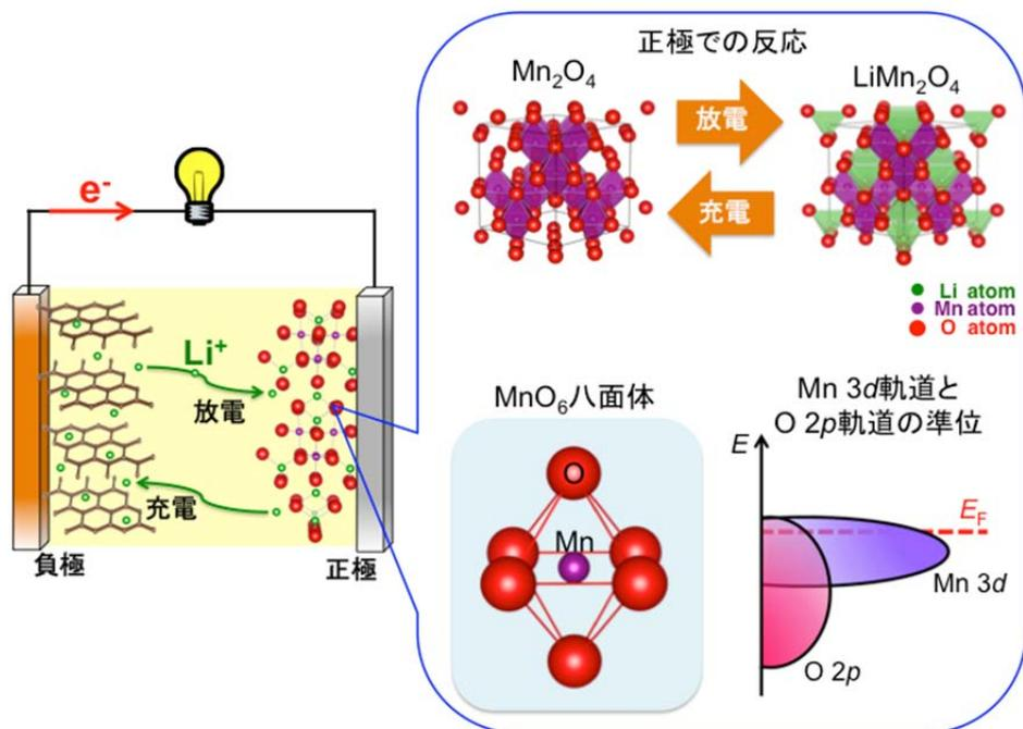
リチウムイオン二次電池では、リチウムイオンが正極、負極間を移動することで充放電が行われます。母材のマンガン酸 ( $Mn_2O_4$ ) は、酸素原子でつくる八面体の中心にマンガン原子が存在する構造を持つため、リチウム挿入によってもたらされた電子の入る軌道（電池電極反応に寄与する軌道）としてマンガン 3d 軌道、もしくは、酸素 2p 軌道のどちらかが予想されます。
