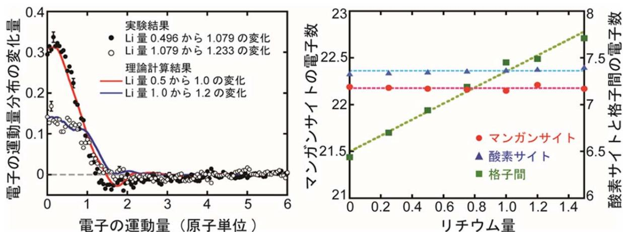
左図が実験から求めた差分コンプトンプロファイルと KKR-GPA 法で計算した差分コンプトンプロファイルの比較です。実験と計算は、良い一致を示しました。右図が、計算から求めたリチウム量に対するマンガサイト（赤色）、酸素サイト（青色）、格子間（緑色）での電子数の変化です。リチウム量の増加に対して、格子間（酸素  $2p$  軌道）では電子数が増加し酸素サイトでもわずかに電子数が増えています。一方、マンガサイトの電子数は変わりません。
