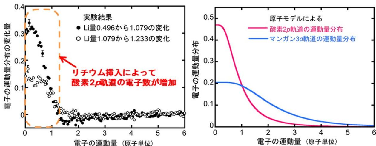
左図が実験から求めた差分コンプトンプロファイルです。運動量が 1.5 原子単位以下の電子数が増大しています。これは、リチウム挿入によって格子間（酸素  $2p$  軌道）の電子数が増加していることを意味しています。右図が、原子モデルのマンガ  $3d$  電子と酸素  $2p$  電子のコンプトンプロファイルです。実験で得られた差分コンプトンプロファイルは、酸素  $2p$  電子のコンプトンプロファイルに近い形をしています。
